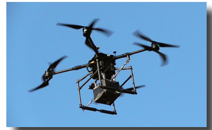
グリーンレーザースキャナを搭載したドローン
