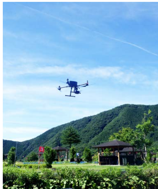
MATRICE300RTK による空撮状況
